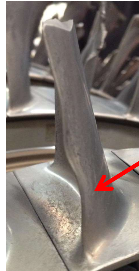
Déformation du pied de pale (Impact oiseau)
