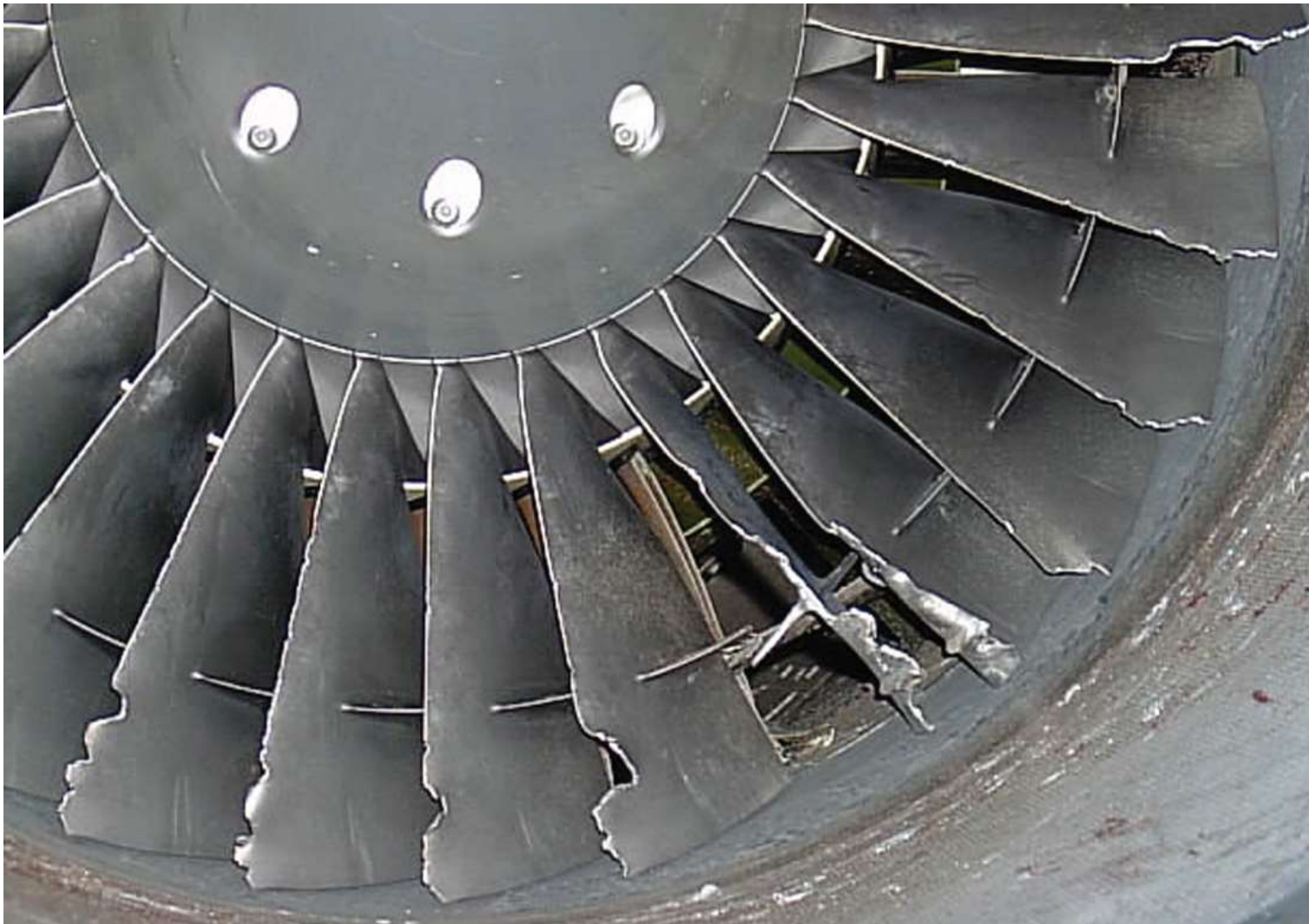
Exemple de FOD facile à traiter en escale : Arrêt des vols immédiat
